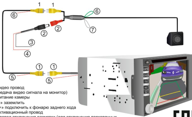
1. Видео провод (передача видео сигнала на монитор)
